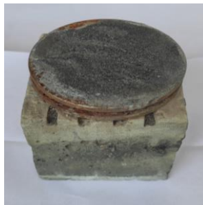
Рис. 3. Зразок куба із торкретбетonom на фрезерованій поверхні
