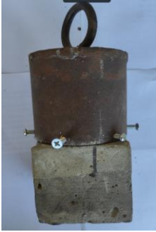
Рис. 8. Зразок шорсткої поверхні торкретбетону в обоймі
