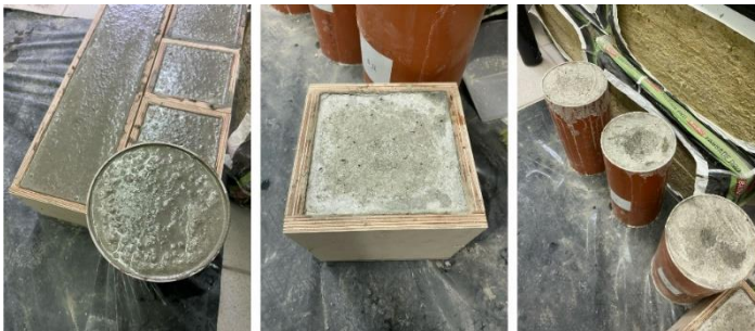
Рис. 3. Процес виготовлення експериментальних зразків – циліндрів і кубів
