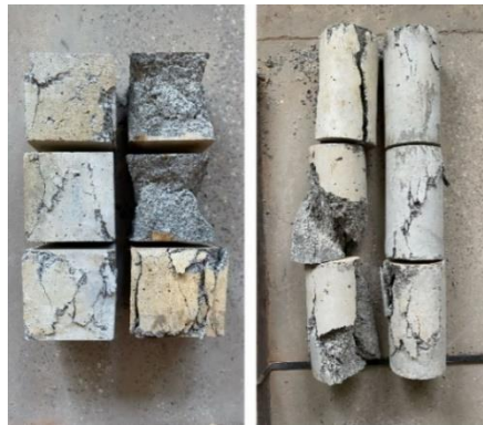
Рис. 5. Прояв ефекту «мостіння» тріщин сталевими волокнами (англ. crack-bridging effect )
