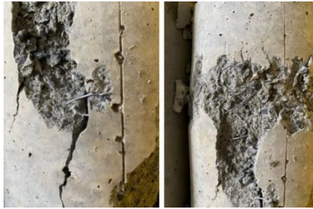
Рис. 4. Дослідні зразки після руйнівного випробування на стиск
