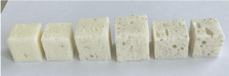
Рис. 2. Серія дослідних зразків ППУ
