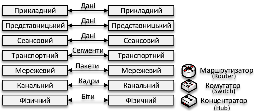
Рисунок 11.2 – Еталонна модель взаємодії ВОС
