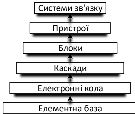
Рисунок 2.3 – Спрощена структура складу системи зв'язку
