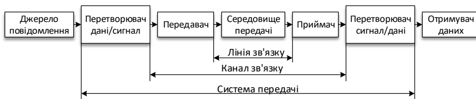
Рисунок 3.1 – Узагальнена система електрозв'язку
