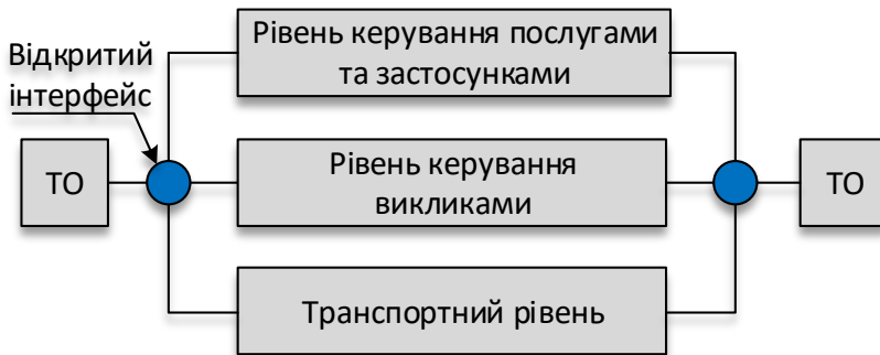
Рисунок 9.1 – Багаторівнева архітектура концепції NGN
