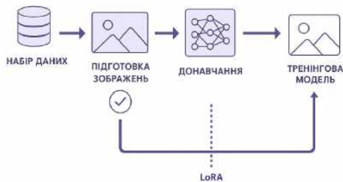
Рисунок 1.4 – Схема тренування генеративної моделі
