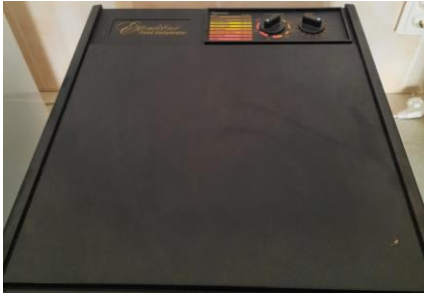
Рисунок 9.1 – Сушильна установка для визначення зміни вологості матеріалу
