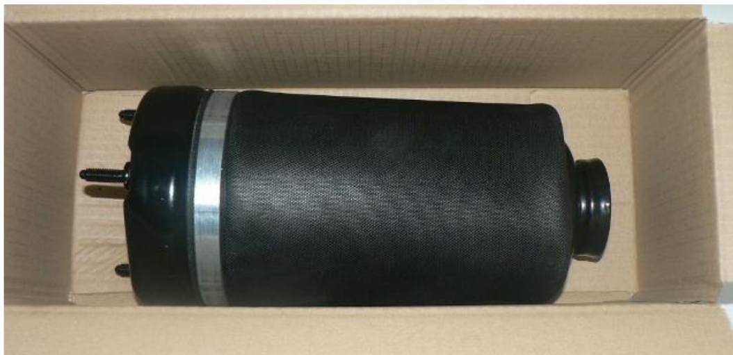
Рисунок 4.2 - Пневмобалон у зібраному вигляді автобуса VDL Citea LLE120.225
