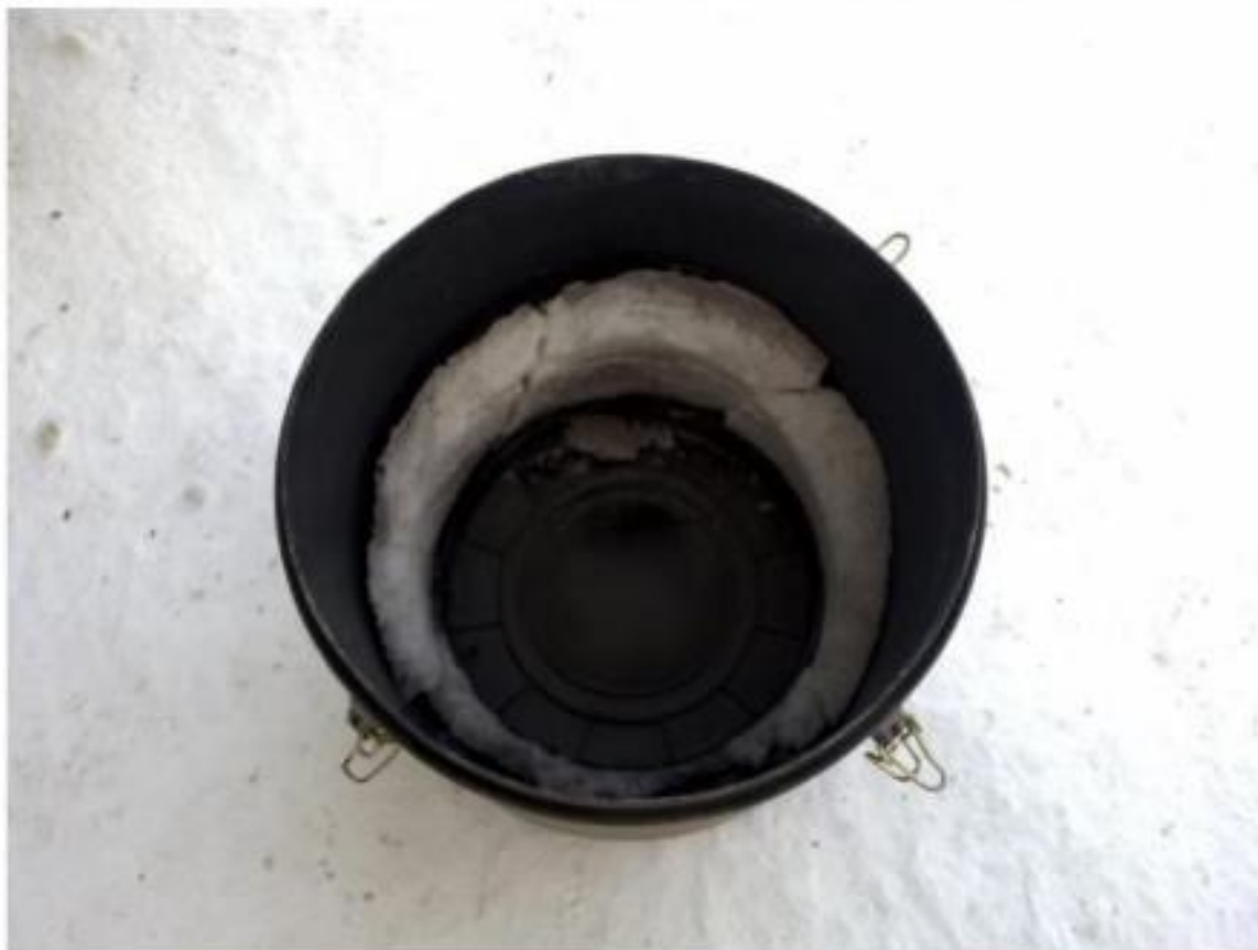
Рисунок 3.5 - Утворення крижаної кірки у захисному кожусі пневмобалона автобуса VDL Citea LLE-120
