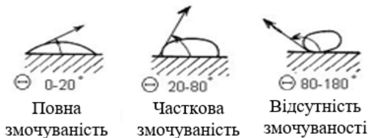
Рисунок 10.3 – Змочування металевої поверхні деталей, що спаюються
