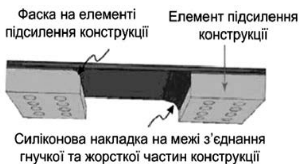
Рисунок 8.11 – Конструктивні елементи для з'єднання гнучкої та жорсткої частин друкованої плати
