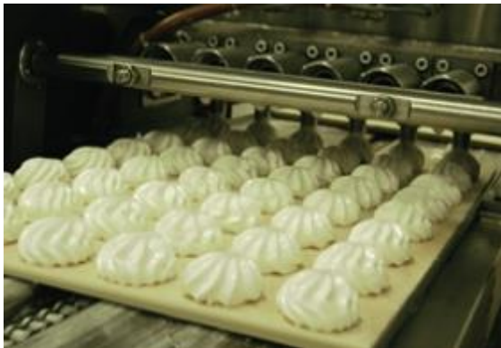
Рисунок 10.6 – Принцип роботи відсаджувальної машини для зефіру [16]
