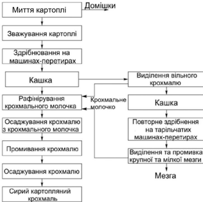
Рисунок 3.6 – Принципово-технологічна схема виробництва картопляного крохмалю
