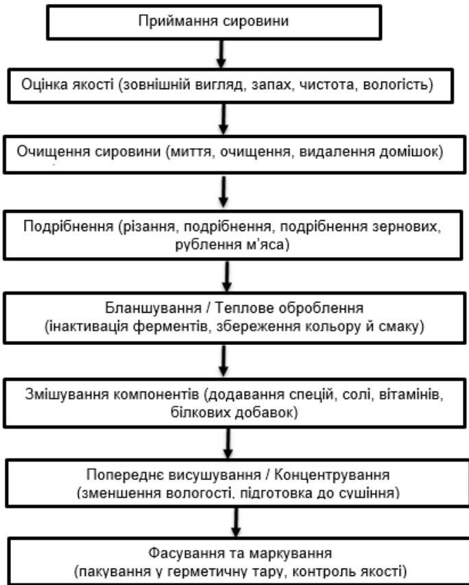
Рисунок 5.1 – Схема технологічного процесу приготування харчових концентратів
