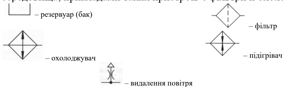
Рисунок 5.13 – Позначення деяких пристроїв, що здійснюють підготовку робочого середовища
