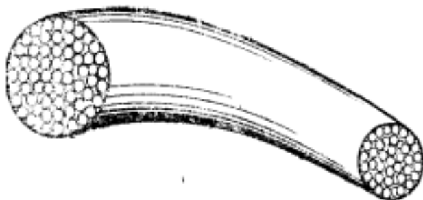
Рисунок 3.20 – Поняття елементарного струмення
