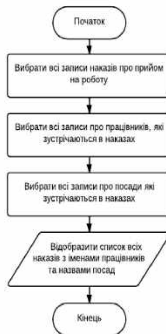
Рисунок 2.13 – Блок-схема алгоритму реалізованого в методі Index класу EmploymentOrdersController
