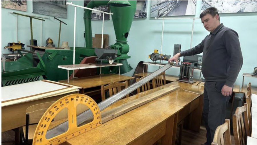
Рисунок 3.6 – лабораторна установка для вимірювання кута тертя та кута перекошування бульб картоплі
