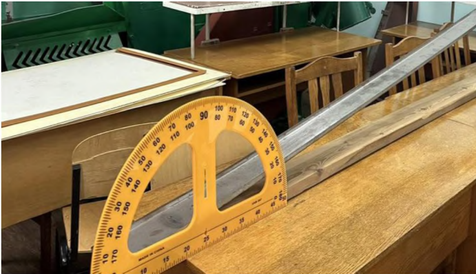
Установка для визначення кута перекочування картоплі та визначення коефіцієнта тертя
