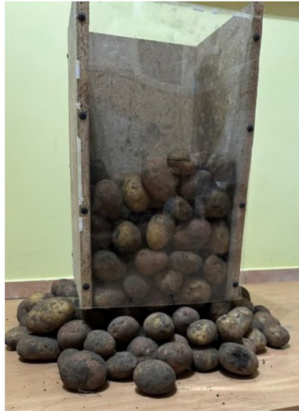
Рисунок 3.4 Лабораторна установка для визначення кута природнього відкосу картоплі
