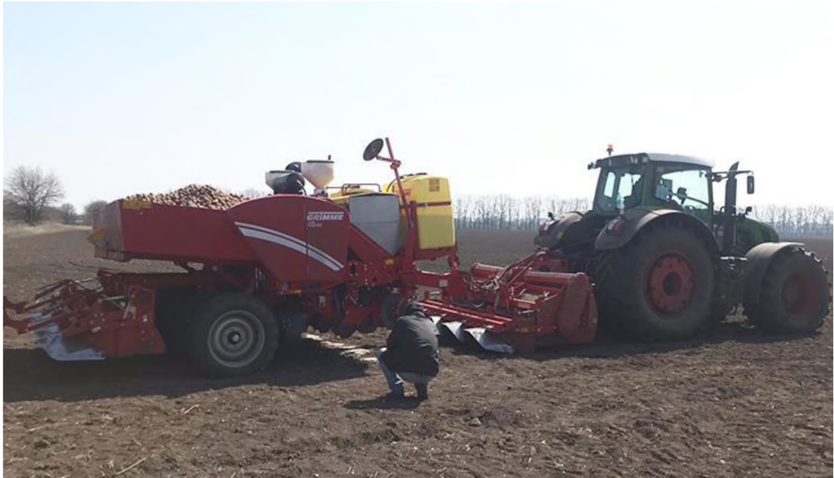
Рисунок 1.5. - Посадковий комплекс Grimme на базі картоплесаджалки GL430 та фрези GF400.
