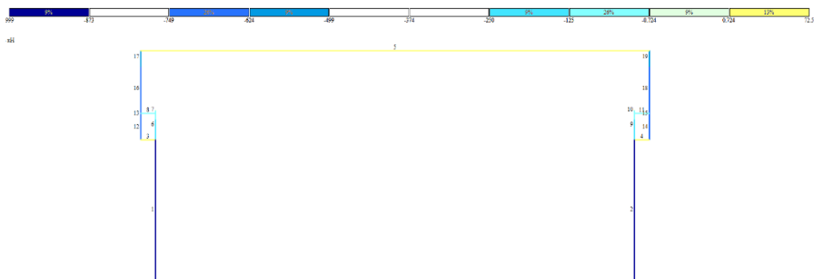
Рисунок 5.38 – Відображення результатів розрахунку у режимі Мозаїка зусиль у стержнях
