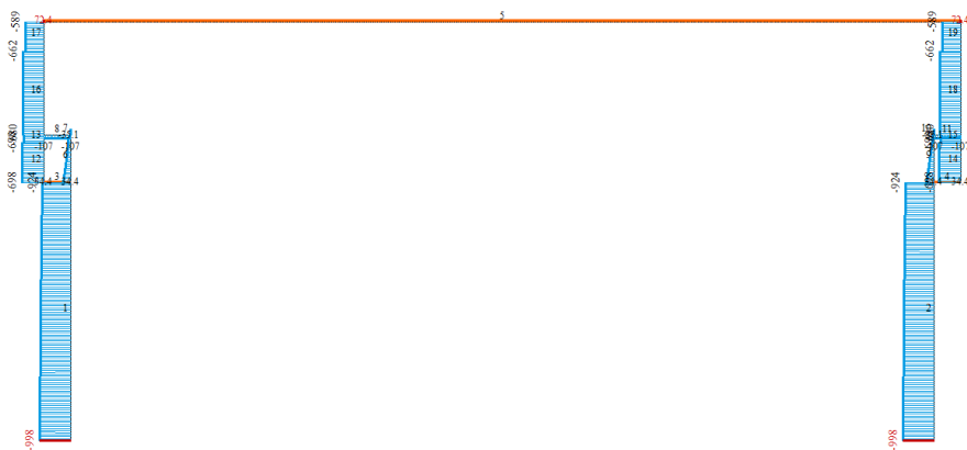
Рисунок 5.36 – Епюра поздовжніх сил в елементах рами (завантаження 1 – Власна вага )
