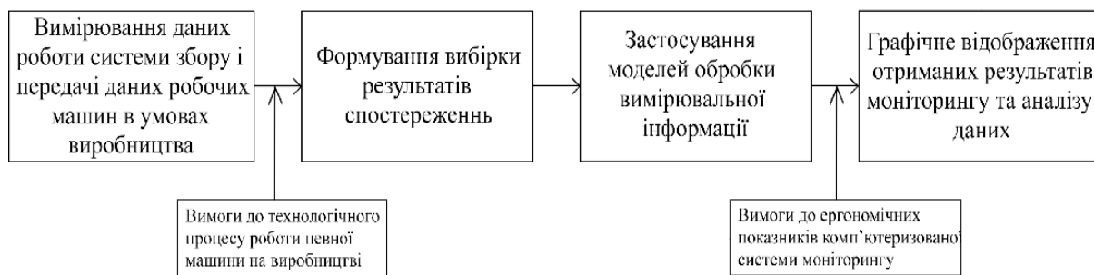
Рисунок 2 – Структурна схема процесів обробки інформації
