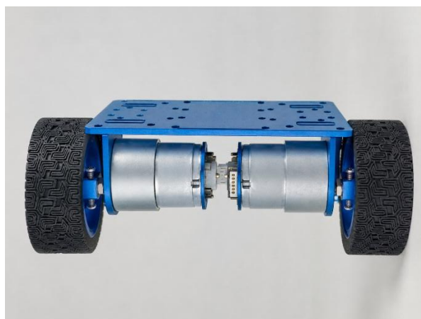
Рисунок 3.4 – Встановлення коліс на вали мотор-редукторів балансуємого робота
