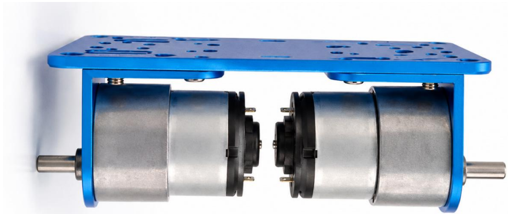
Рисунок 3.3 – Монтаж двигунів постійного струму з редукторами на основу прототипу
