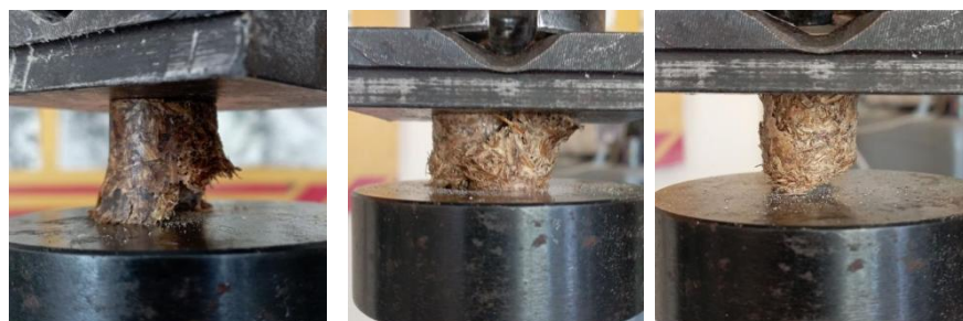
Рисунок 3.9 – Загальний вигляд біокомпозитних зразків після дослідження міцності на стискання із різним вмістом наповнювача;
