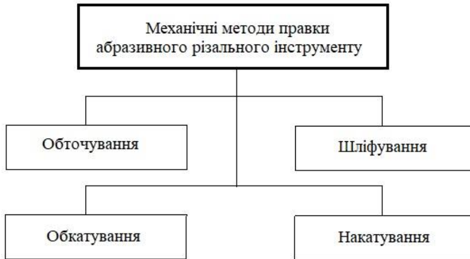
Рисунок 4.2 – Основні способи механічного правлення абразивного різального інструменту [16]
