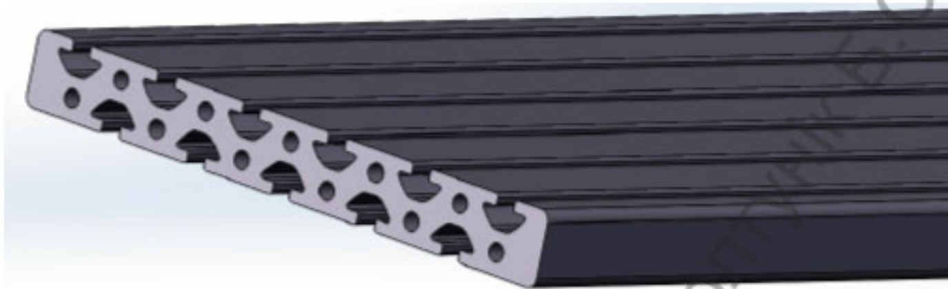
Рисунок 4.7 – Модель основи з алюмінієвого профілю
