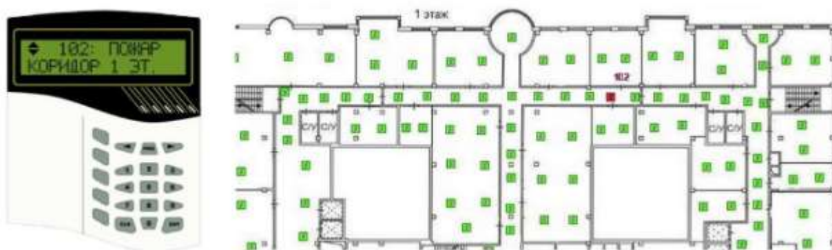
Рисунок 2.8 – Приклад відображення інформації про спрацювання адресного СП з адресою 102 у коридорі першого поверху
