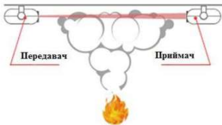
Рисунок 3.5 – Принцип виявлення пожежі лінійним СПД
