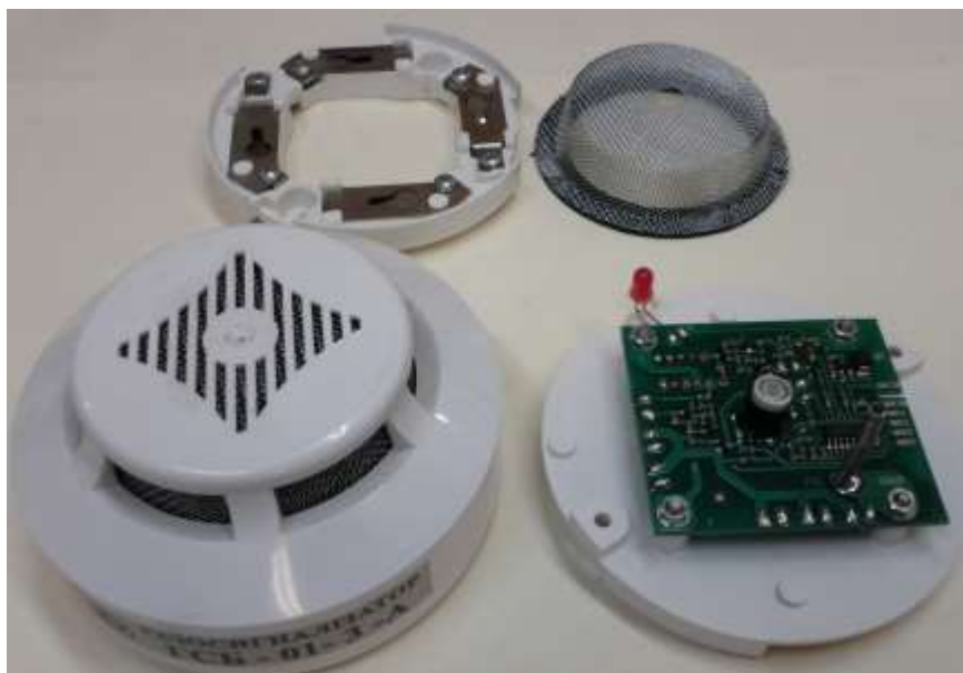
Рисунок 3.12 – Газовий пожежний сповіщувач ГСБ-01-3 у розібраному стані
