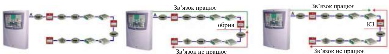
Рисунок 2.12 – Принцип функціонування розімкнутого ШПС в адресно-аналоговій СПС за появи обриву і КЗ
