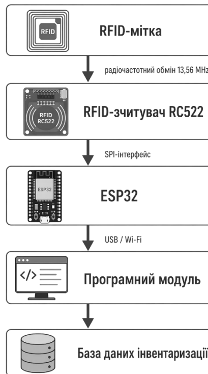
Рисунок 3.2 – Схема взаємодії апаратних компонентів RFID-комплексу
