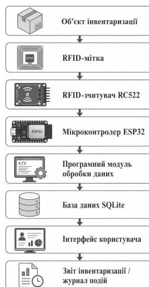
Рисунок 3.1 – Структурна схема програмно-апаратного комплексу для інвентаризації з використанням RFID-міток
