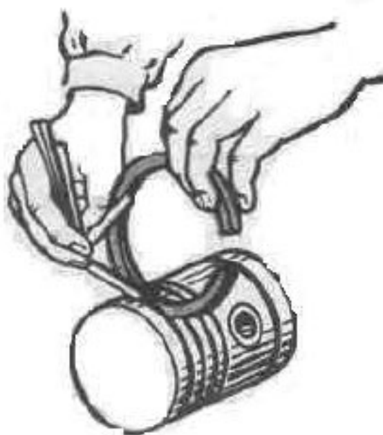
Рисунок 2.6– Перевірка зазору поршневого кільця з канавкою поршня
