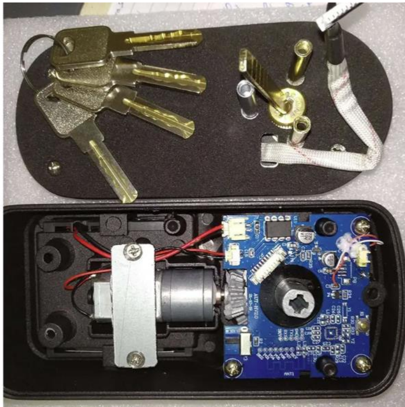
Рисунок 1.5 – Внутрішня будова замка ATIS Lock A20T
