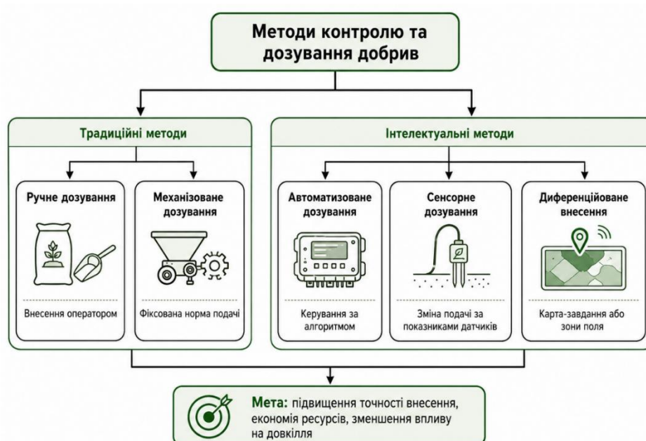
Рисунок 1.3 – Класифікація методів контролю та дозування добрив у сільськогосподарських процесах [4]
