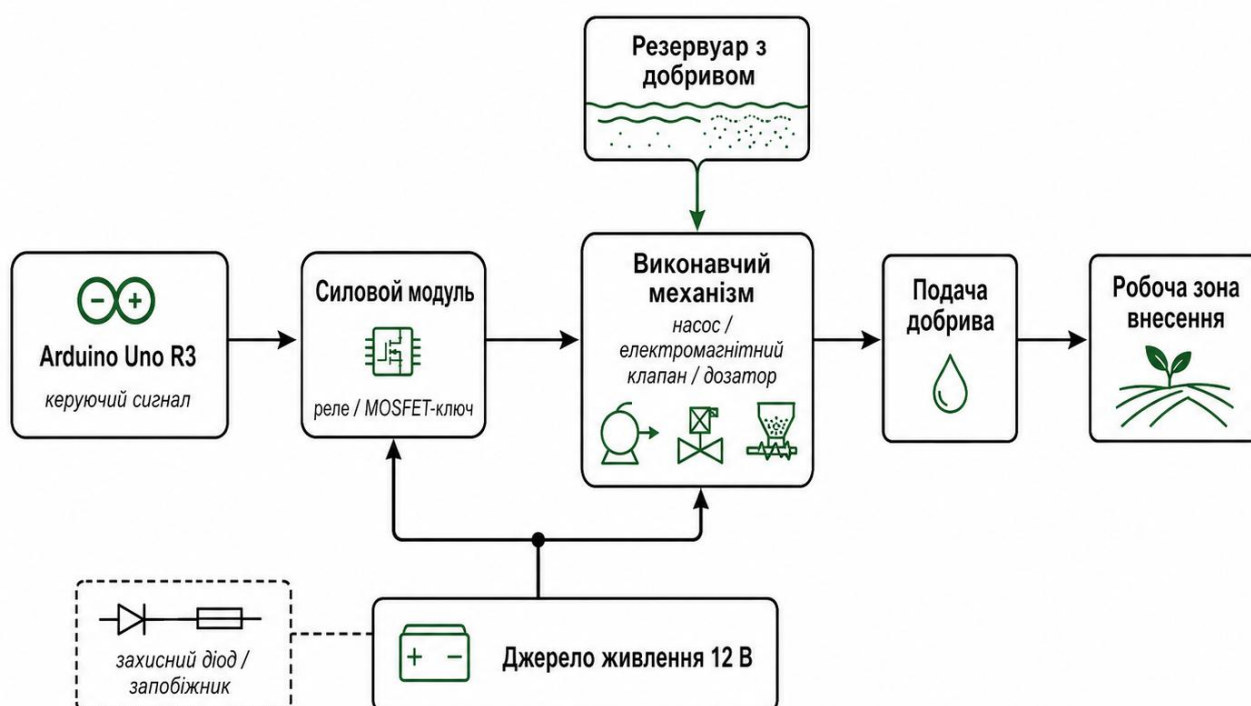
Рисунок 2.4 – Структура виконавчої частини системи дозування добрив [24]
