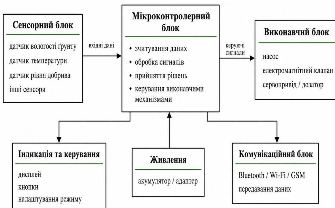
Рисунок 1.5 – Роль мікроконтролера в системі агротехнічного моніторингу та керування
