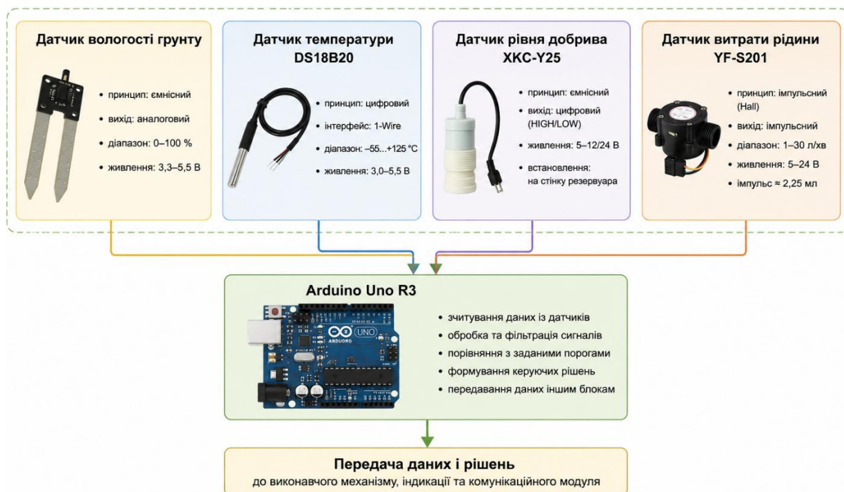
Рисунок 2.1 – Структура сенсорного блоку модуля автоматизованого внесення добрив [20]
