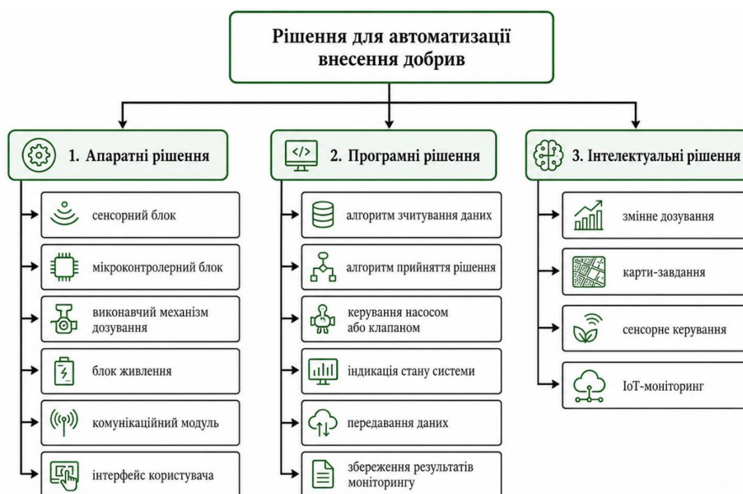
Рисунок 1.8 – Узагальнена структура апаратно-програмного рішення для автоматизації внесення добрив
