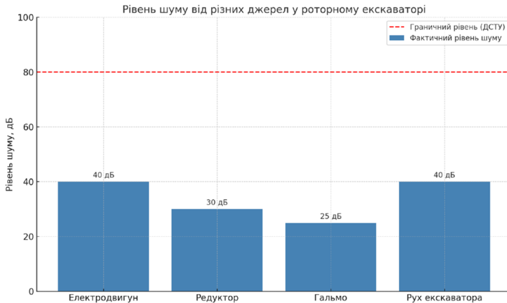
Рисунок 3.1 Рівні шуму від основних джерел у роторному екскаваторі порівняно з умовною граничною нормою (80 дБ) відповідно до ДСТУ
