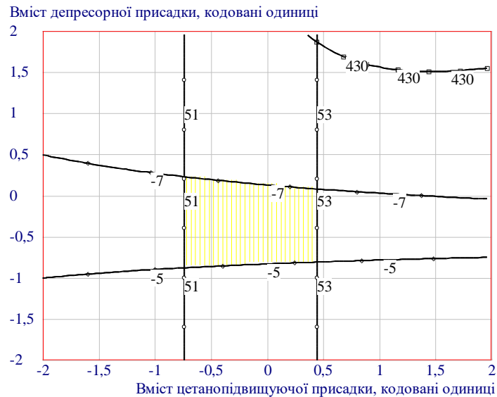
Рис. 3.10. Компромісна область оптимального складу дизельного палива із використанням біокомпонента
