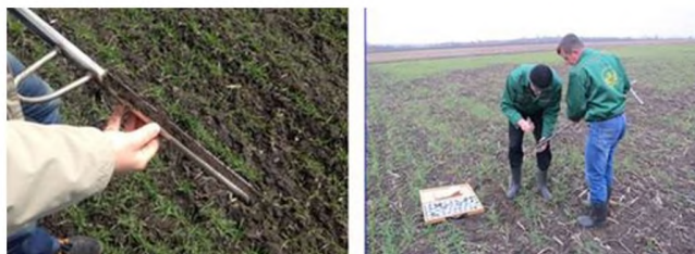
Відбір проб ґрунту за допомогою буру
