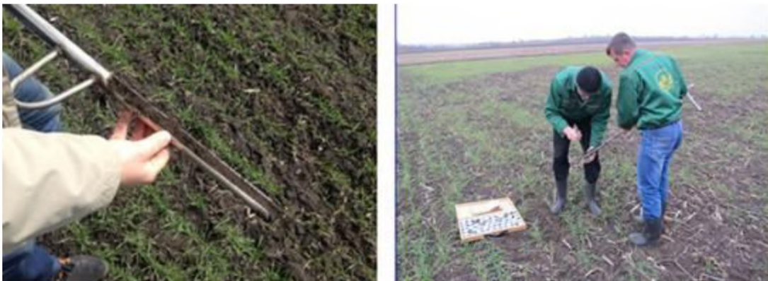
Рисунок 3.4 - Відбір проб ґрунту за допомогою буру
