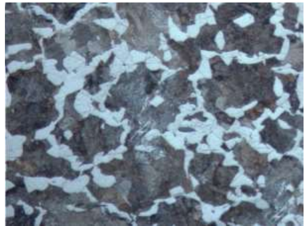
Рисунок 3.4 – Структура поковок помельних куль
