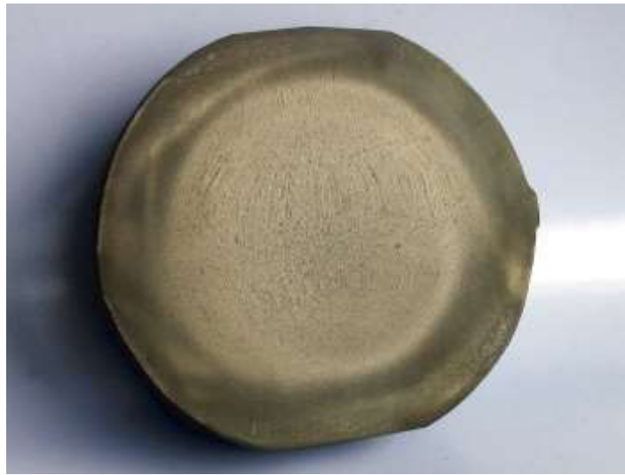
Рисунок 4.2 – Макроструктура помельних куль після гартування у воді
