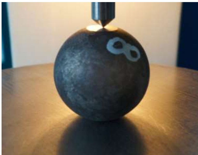
Рисунок 3.5 – Вимірювання поверхневої твердості куль
