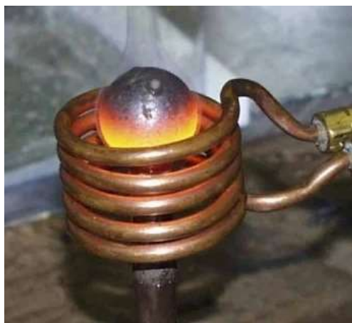
Рисунок 4.1 – Нагрівання куль в індукторі СВЧ
