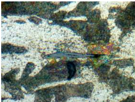
Рисунок 2.3 – Форма неметалевих включень в гарячекатаному прокату сталі 70Г (x1000)
