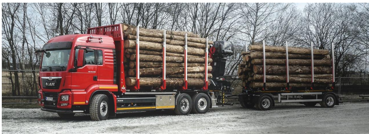
Рисунок 1.1 – Багатоланковий колісний лісовоз на базі автомобіля MAN моделі TGX
