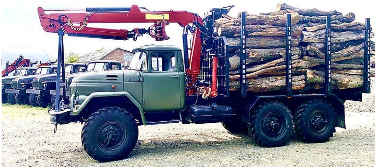
Рисунок 1.5 – Колісний лісовоз на базі автомобіля ЗИЛ-131
