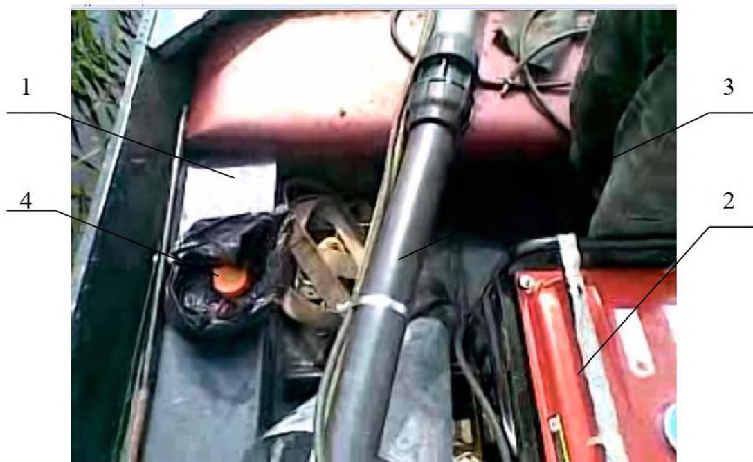
Рисунок 3.4. Фото випробувань забірною пристрою: 1 – плавзасіб, 2 – генератор, 3 – забірний пристрій, 4 – глибиномір (вимірювальна рулетка)
