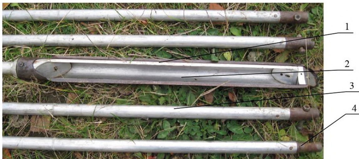
Рисунок 3.1. Фото відбірника проб: 1, 2 – відповідно рухомий і нерухомий човникоподібний півциліндр, 3 – подовжувальний тримач, 4 – фіксатори
