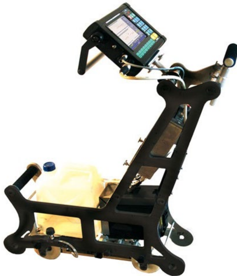
Рисунок 1.4 – Ультразвуковий однопітквий рейковий дефектоскоп УДС2-77 [4]
