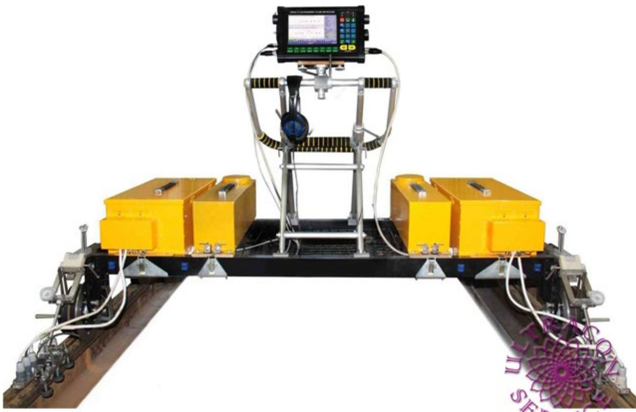
Рисунок 1.2 – Ультразвуковий рейковий дефектоскоп УДС2-73 [2]
