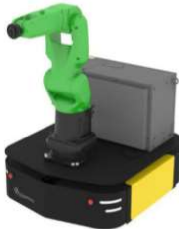
Рисунок 1.5 – Платформа RIDGEBACK, оснащена маніпулятором Fanuc
