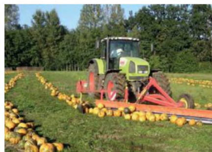
Рисунок 2.11 – Валкоутворювач плодів гарбузів марки «MOTY» («Kröpfel Landmaschinen GmbH», Австрія)
