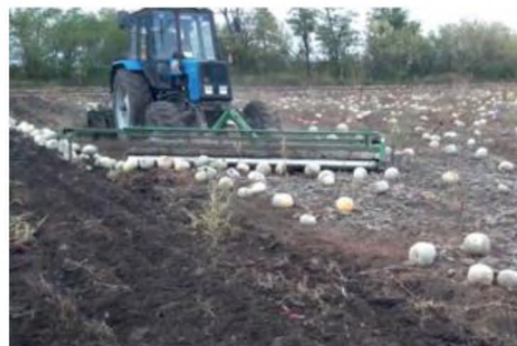
Рисунок 2.10 - Валкоутворювач плодів гарбуза V-VZ.001 (ПрАТ “Каховський експериментальний машинобудівний завод”, Україна)
