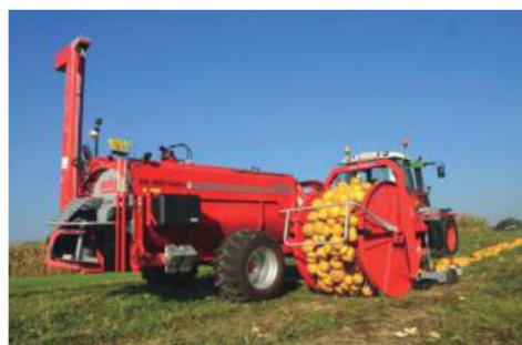
Рисунок 2.14 – Комбайн для збирання гарбузів і відділення насіння марки «MOTU» («Kröpfel Landmaschinen GmbH», Австрія)
