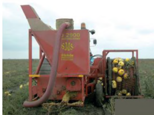
Рисунок 2.13 – Комбайн для збирання гарбузів і відділення насіння TD-2900 (компанія «SMS», Туреччина)
