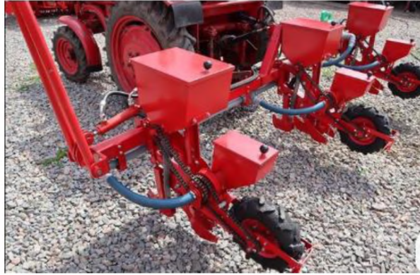
Рисунок 2.7 – Сівалка точного висіву СУ-2 (двосекційна універсальна для посіву гарбузів, кавунів).
