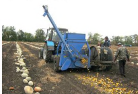
Рисунок 2.12 – Причіпний комбайн для збирання плодів гарбузів з виділенням насіння V-VD.04 (ПрАТ “Каховський експериментальний машинобудівний завод”, Україна)
