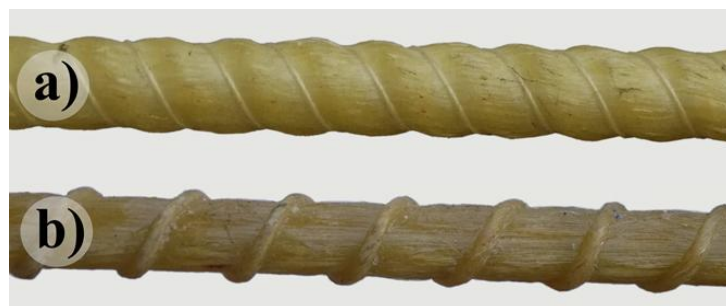
Рис. 6.1. Вид поверхні склокомпозитної арматури: а) склокомпозитна арматура Ø16АКС800 виробництва ТОВ Технологічної групи «ЕКІПАЖ» (м.Харків); б) технічний дизайн поверхні арматури іншого виробника
