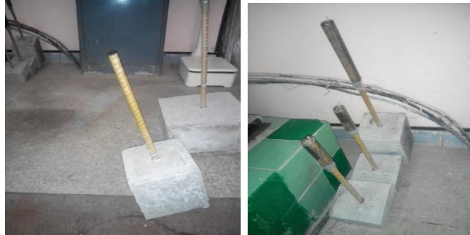
Рис. 6.4. Захист арматурного стержня від пошкоджень преса ЕКСПЕРИМЕНТАЛЬНІ ДОСЛІДЖЕННЯ
