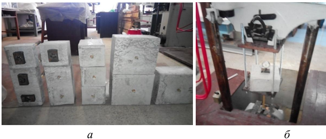
Рис. 6.3. Дослідні зразки – бетонні призми: а – загальний вигляд бетонних призм; б – загальний вигляд випробування зразків
