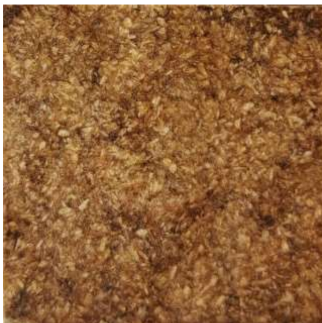
Рисунок 4.4 – Структура зразка з поліетиленовою матрицею(x10)
