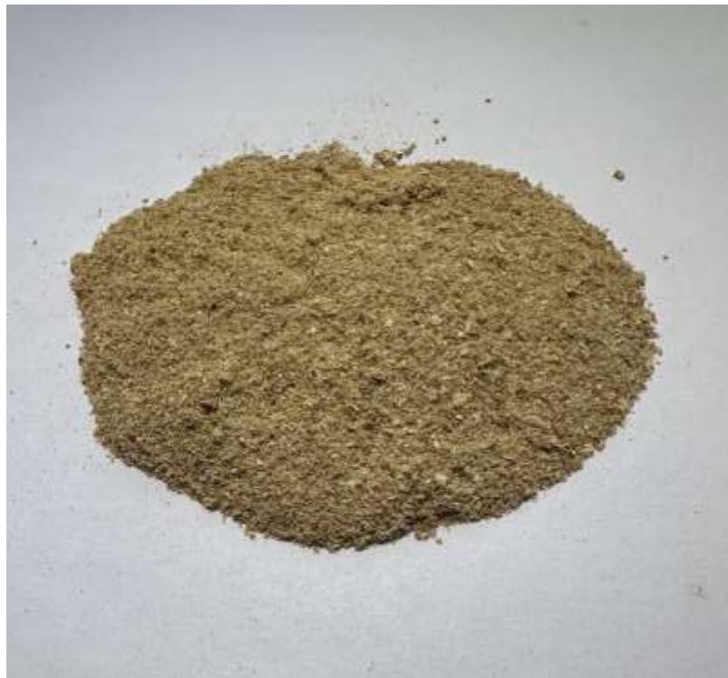
Рисунок 2.3 – Загальний вигляд деревного дубового борошна після калібрування
