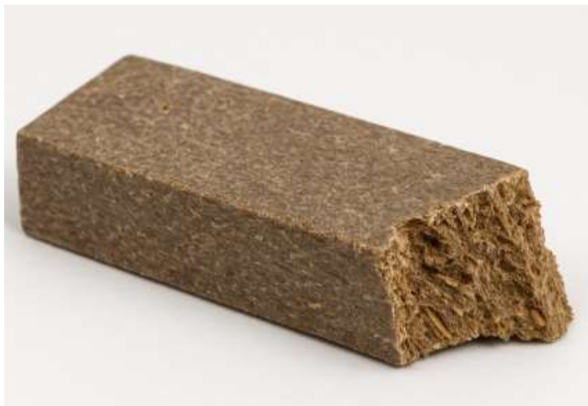
Рисунок 3.4 – Загальний вигляд зразка з поліетилентерефталатної матриці, після випробування на міцність
