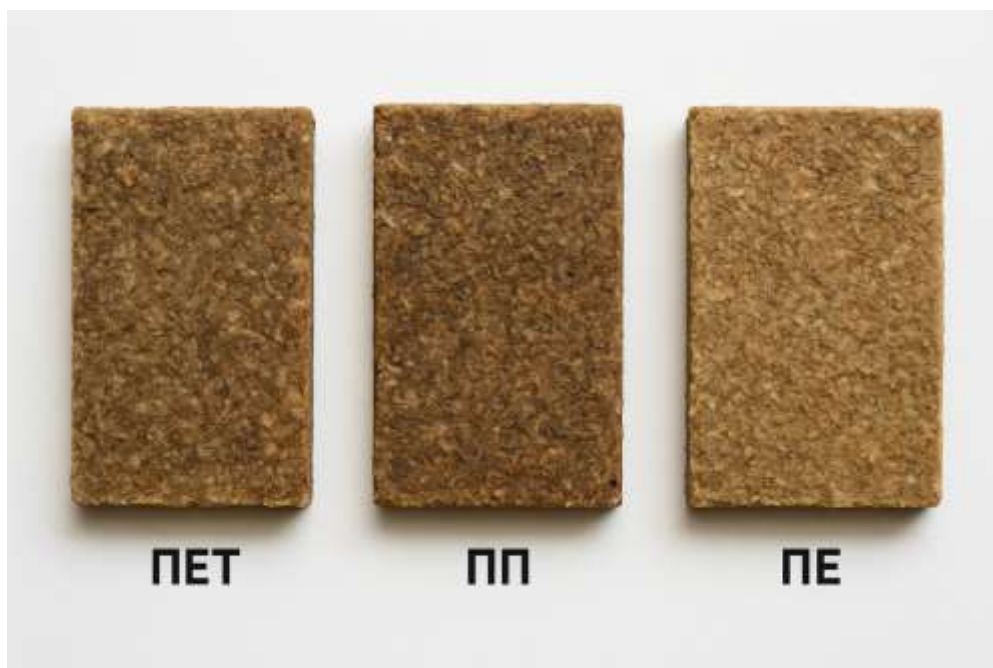
Рисунок 3.1 – Загальний вигляд виготовлених зразків деревно-пластикових композитів
