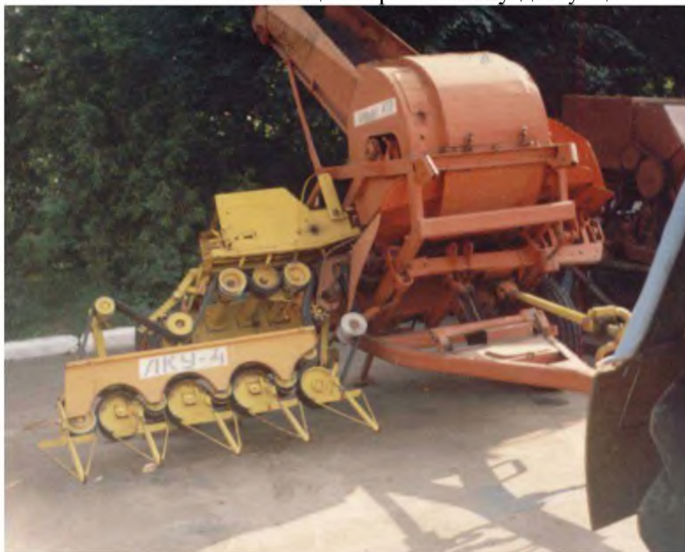
Рис. А.1. Льонозбиральна машини з розробленим бральним пристроєм (варіант для комбайнового збирання)
