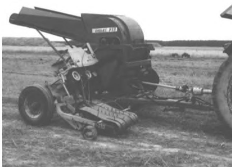
Рис. А.2. Льонозбиральна машини з розробленим підбирально-повертальним пристроєм (варіант для роздільного збирання)
