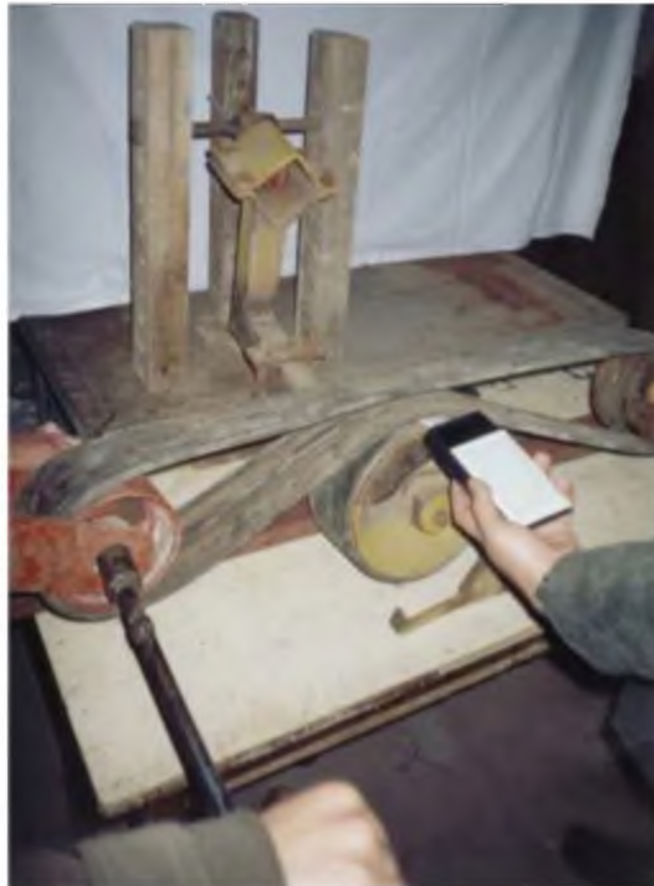
Рисунок. 3.4 – Фото дослідження впливу перекосу встановлення шківа на тиск в криволінійному рівчаку
