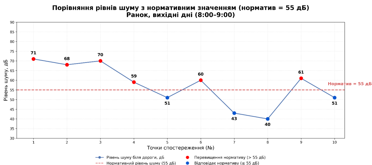
Рисунок 3.3. Результати вимірювань показників шумового забруднення за допомогою Додатку (ранок, вихідні дні 8:00 – 9:00).
