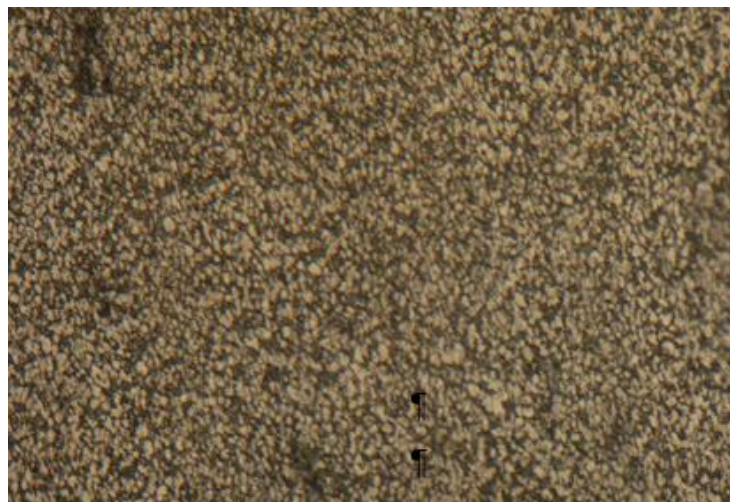
Рисунок 3.5 – Мікроструктура зразка титанового сплаву ВТЗ-1 \times 100
