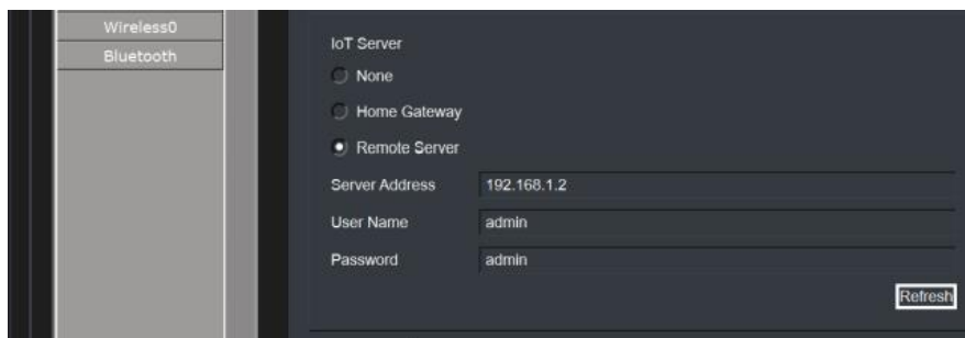
Рисунок 3.19 – Підключення IoT-пристроїв до IoT-сервера
