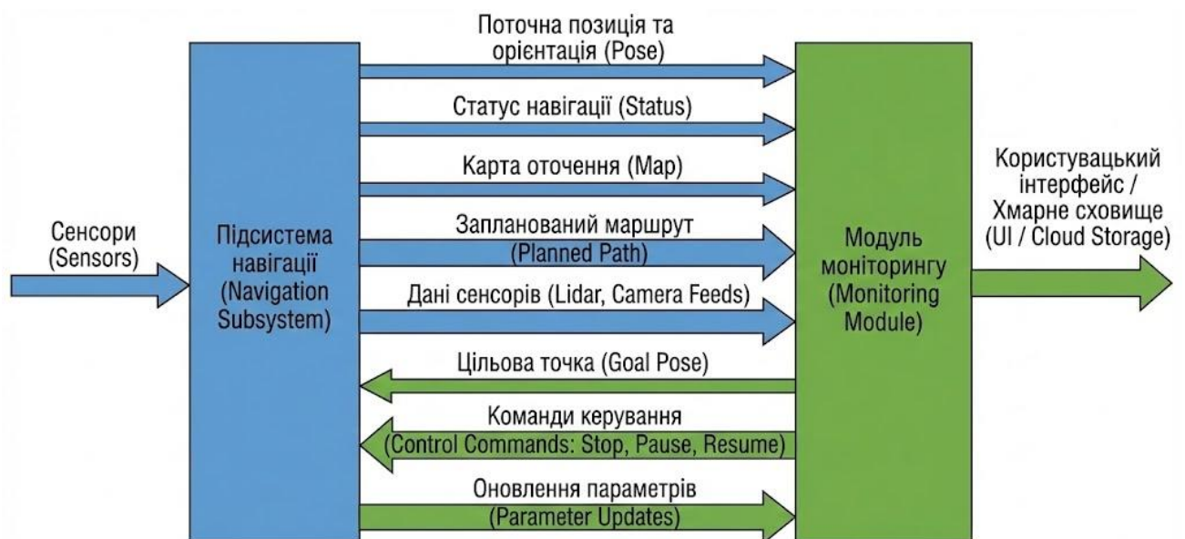
Рисунок 2.2 – Схема інформаційних потоків між підсистемою навігації та модулем моніторингу [16]
