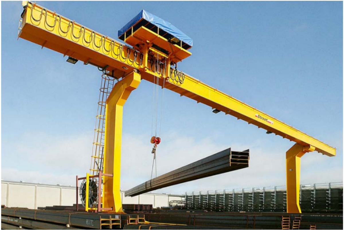
Рисунок 1.2 Кран із канатною моделлю візка
