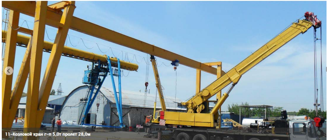
Рисунок 1.5 Кран козловий г-п 5,0 тон
