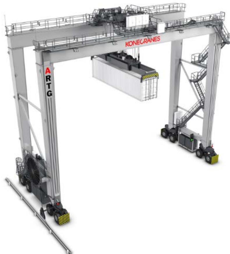
Рисунок 1.7 16-колісний портовий кран RTG з пневмоколісним ходом
