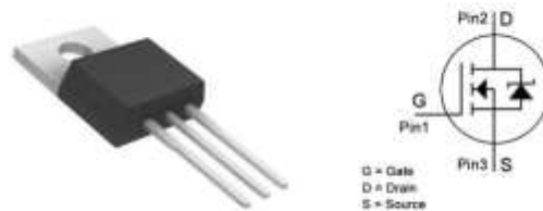
Рисунок 2.6 – Корпус TO-220AB та умовне графічне позначення транзистора IRLZ44N
