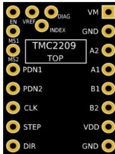
Рисунок 2.5 – Конфігурація та призначення виводів модуля драйвера TMC2209 [7]
