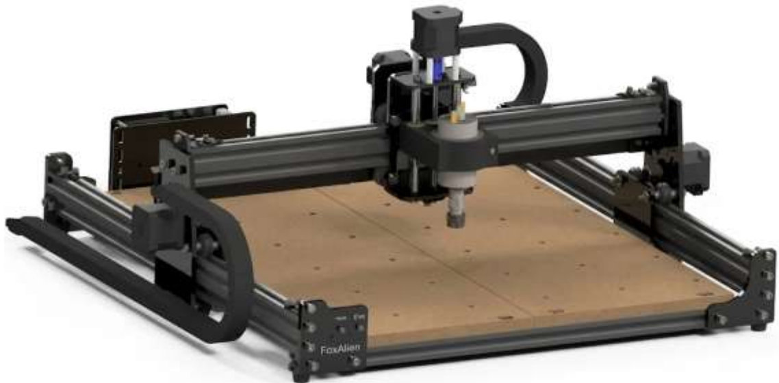
Рисунок 1.1 – Загальний вигляд настільного фрезерного верстата портального типу
