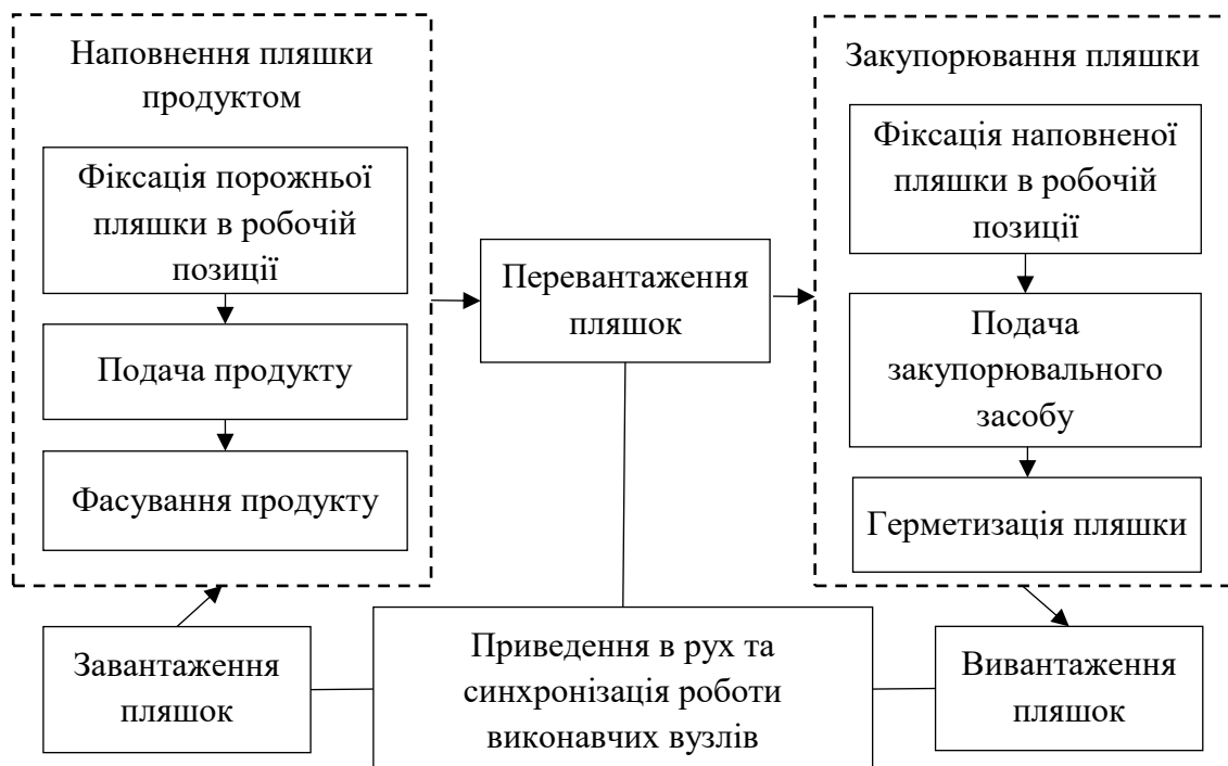
Рисунок 2.4 – Технологічна схема пакування напоїв в скляні пляшки
