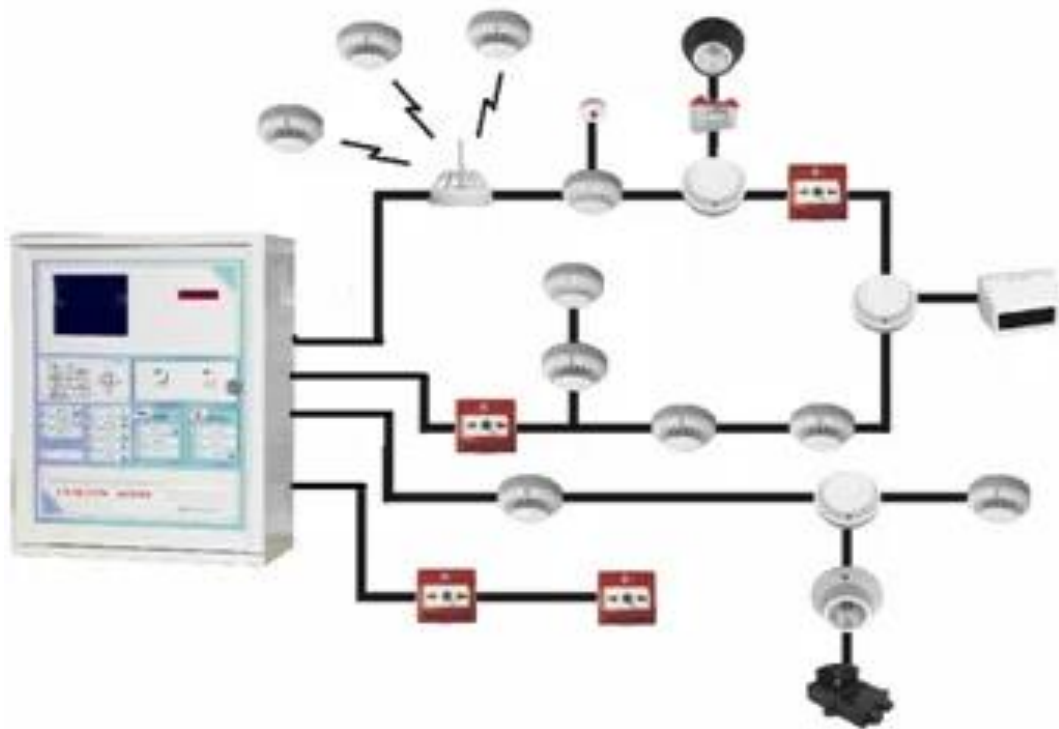
Рисунок 1.3 – Узагальнена структурна схема адресної системи пожежної сигналізації [9]
