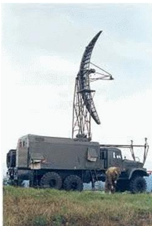
Рисунок 1.10 – Рухомий радіовисотомір ПРВ-16МА [9]
