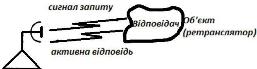
Рисунок 1.2 – Радіолокація з активною відповіддю [1]
