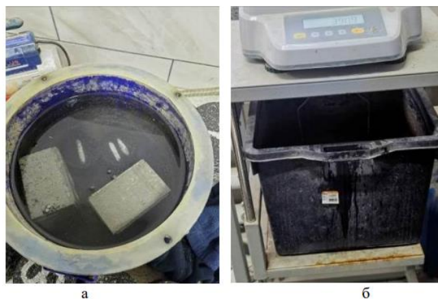
Рисунок 7.12 Визначення середньої густини фрезерованого матеріалу (стабілізованого та укріпленого): а) витримування у резервуарі з водою зразків; б) зважування у воді зразка.
