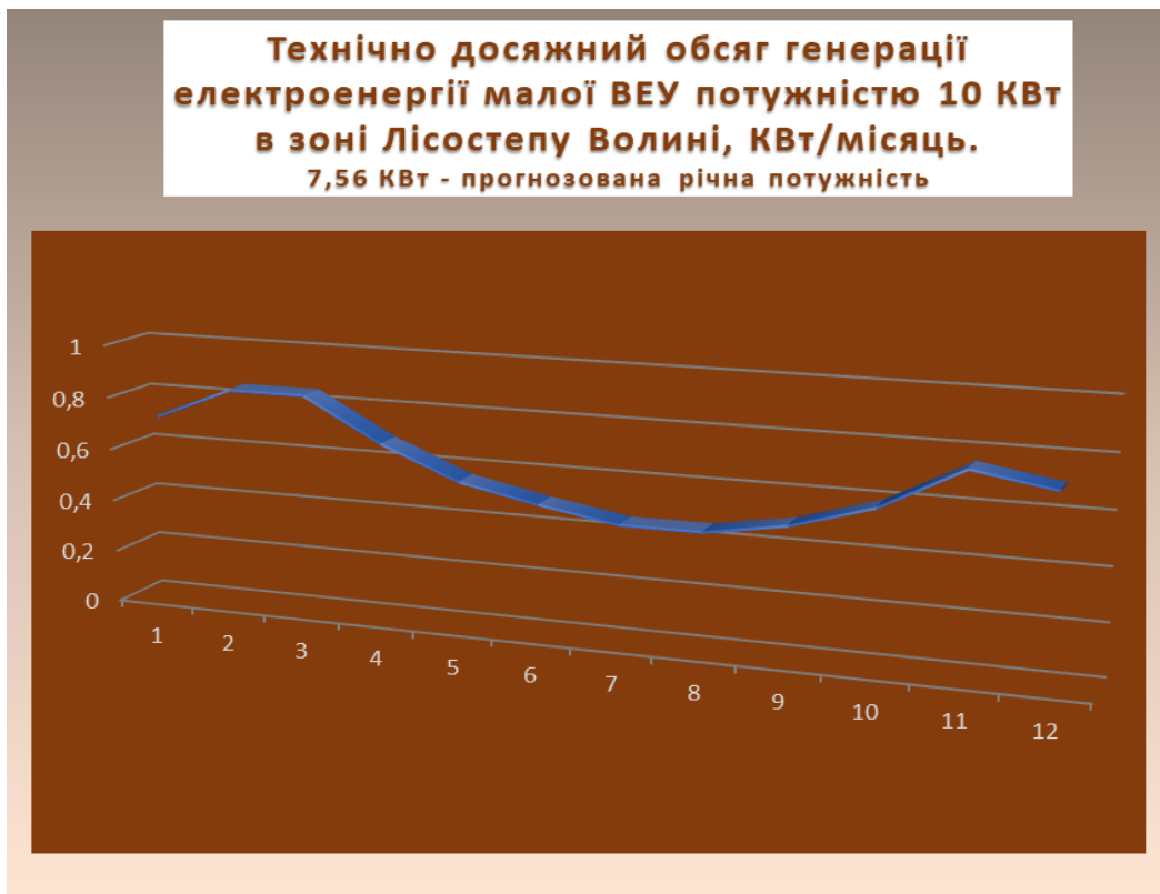
Рисунок 3.6 Технічно досяжний обсяг вітрогенерації електроенергії у Лісостеповій зоні Волинської області при встановленні малої ВЕУ потужністю 10 кВт.
