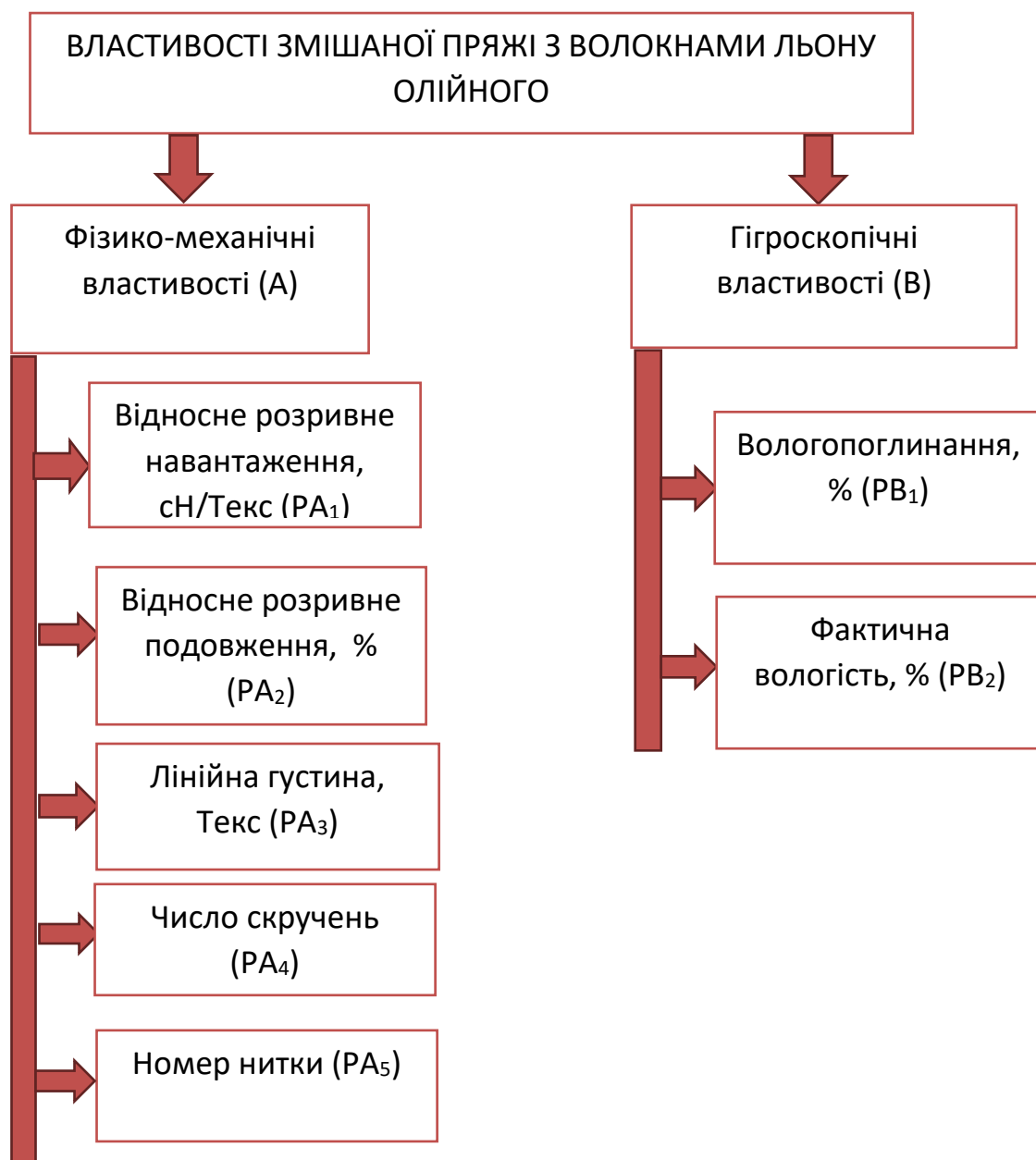
Рис. 5.1. Структура показників найважливіших споживних властивостей змішаної пряжі на основі волокон льону олійного
