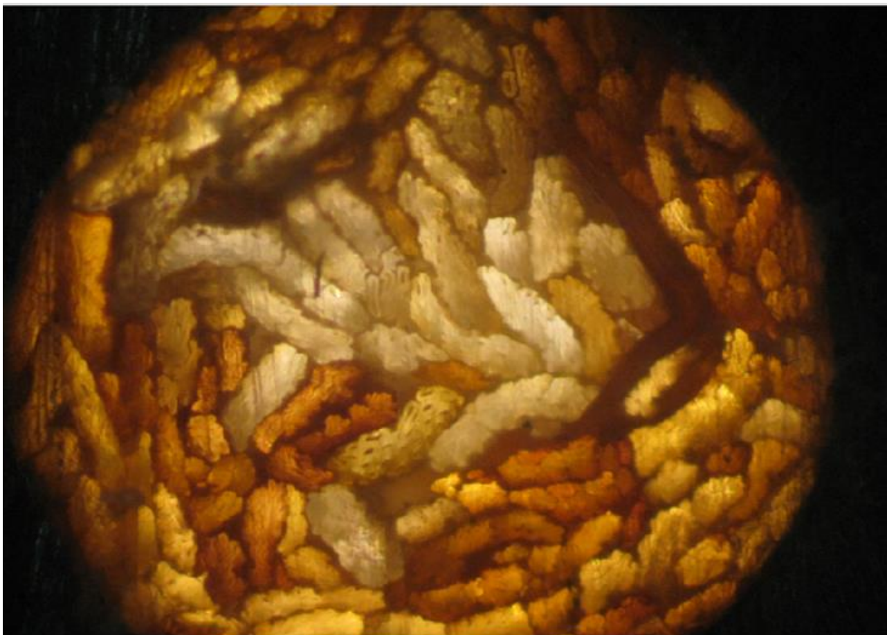
Рис. 3.11. Поперечний зріз пучків волокон льону олійного сорту Айсберг
