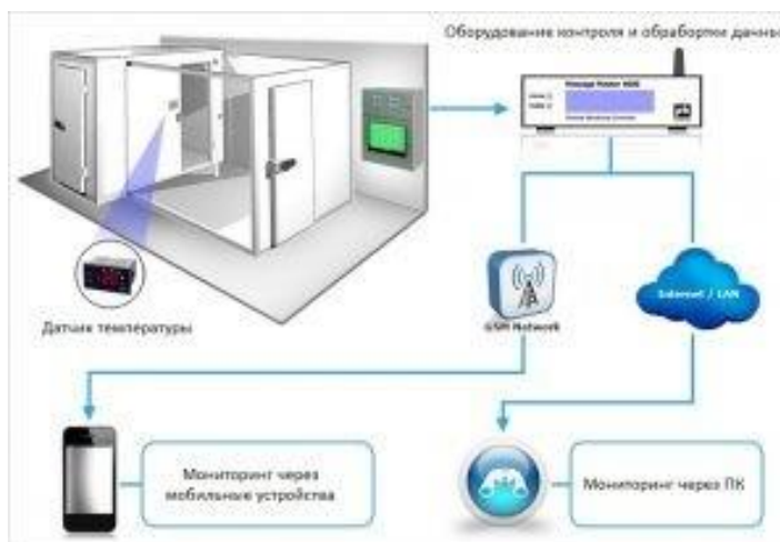
Рисунок 1.9 – Моніторинг обладнання за допомогою стільникової мережі
