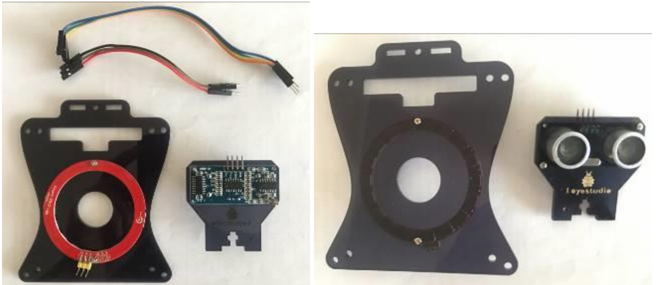
Рисунок 3.17 – Установка модуля KEYES-2812-18R та датчика HC-SR04
