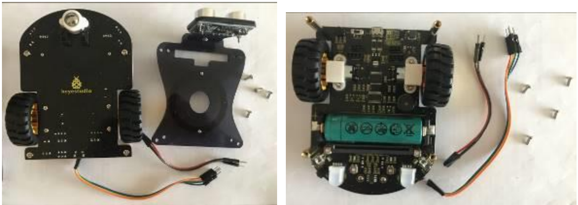
Рисунок 3.19 – Зібрані щитки робоплатформи
