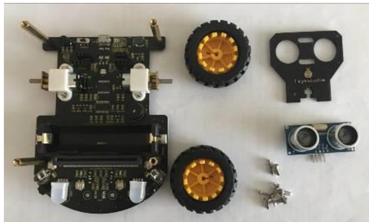
Рисунок 3.10 – Комплектуючі робо-платформи системи Micro: bit Mini Smart Rbot
