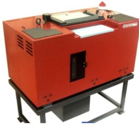
Рисунок 1.1 Машина для двоїння Compact 300, Camoga (Італія)
