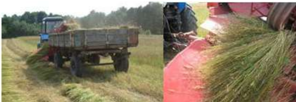
Рисунок 1.4 - Дослідження роздільної технології збирання льону олійного: а - скошування стеблостою роторною косаркою; б – одночасне підбирання двох валків[111]
