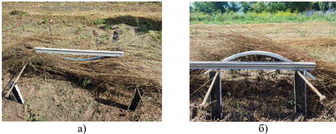
Рисунок 4.6 – Визначення прогину (а) і згину (б) стебел льону
