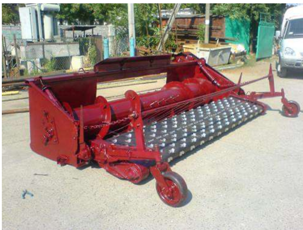
Рис. Б.2 – Підбирач валків ПДЕ – 3.4. працює в агрегаті с комбайнами КЗС - 9 "Славутич", John Deere, Dominator, Massey Ferguson, Claas, Case, New
