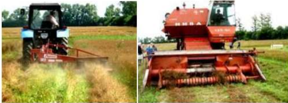
Рисунок 1.4 - Дослідження роздільної технології збирання льону олійного: а - скошування стеблостою роторною косаркою; б – одночасне підбирання двох валків[111]
