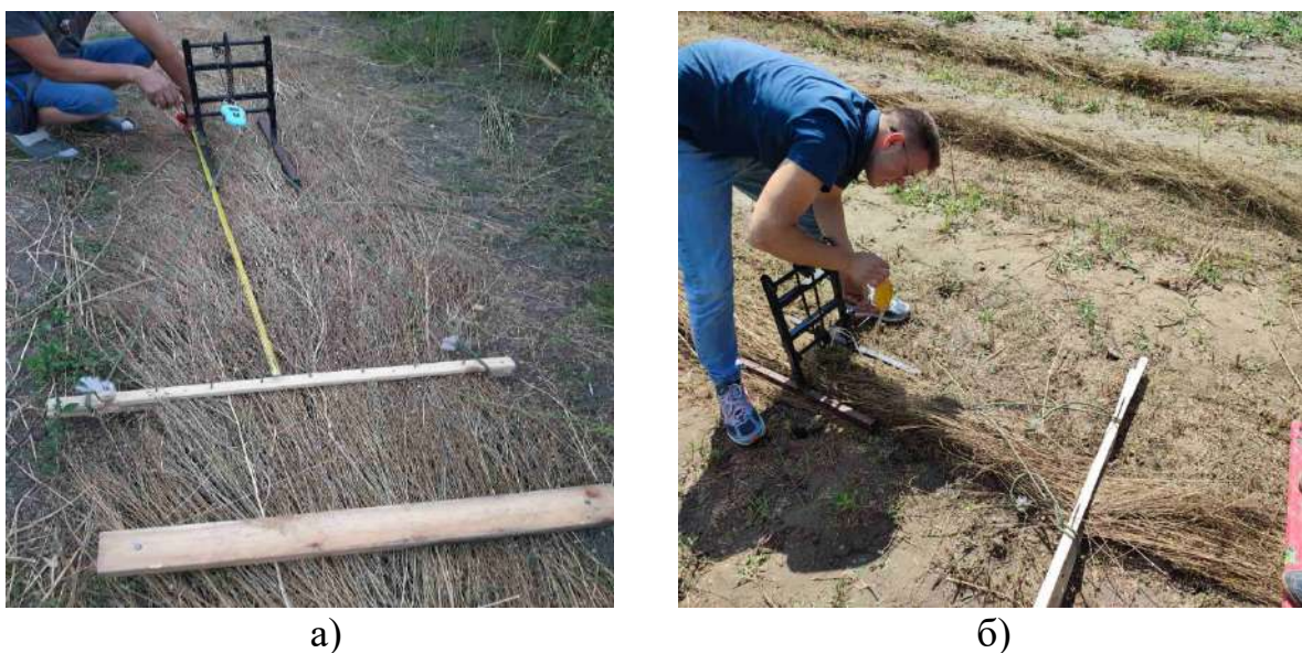
Рисунок 4.10 - Проведення дослідів з визначення сили розтягу валка: а – проведення дослідів з сортом льону-довгунця Міандр у 2023 р.; б – проведення дослідів з сортом льону олійного Антант у 2024 р.
