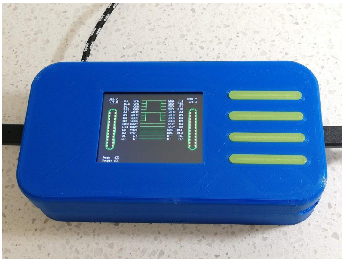
Рисунок 3.9 – Тестування USB Type-C – USB Type-C
