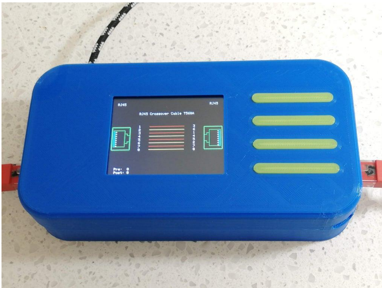
Рисунок 3.11 – Тестування RJ45 – RJ45
