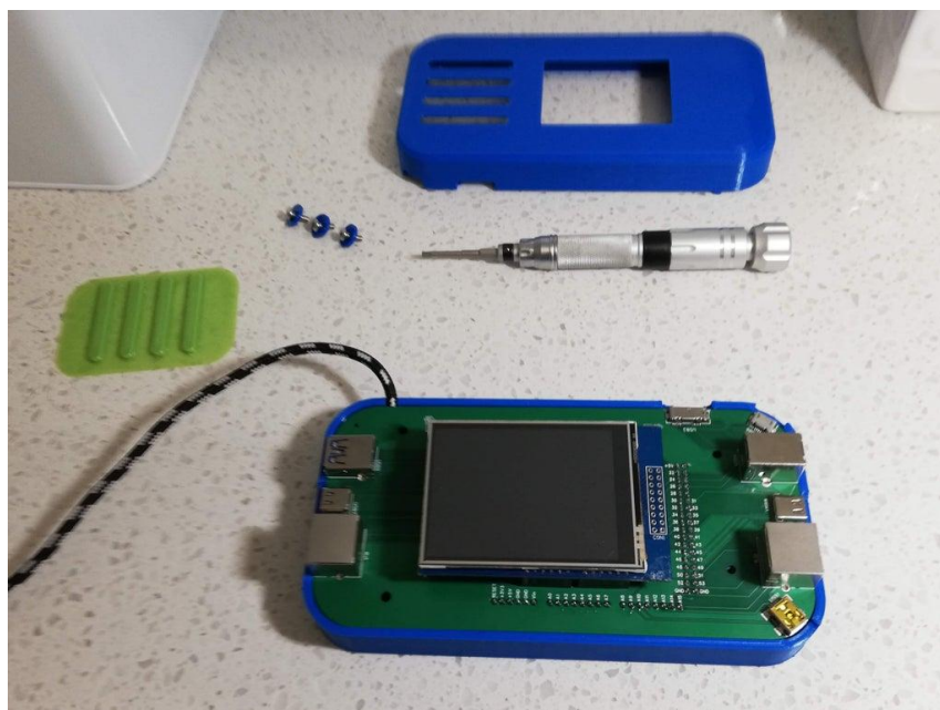
Рисунок 3.4 – Встановлення екрана в нижній корпус
