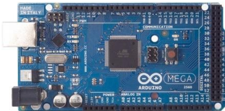
Рисунок 2.1 – Arduino Mega 2560 R3 [13]
