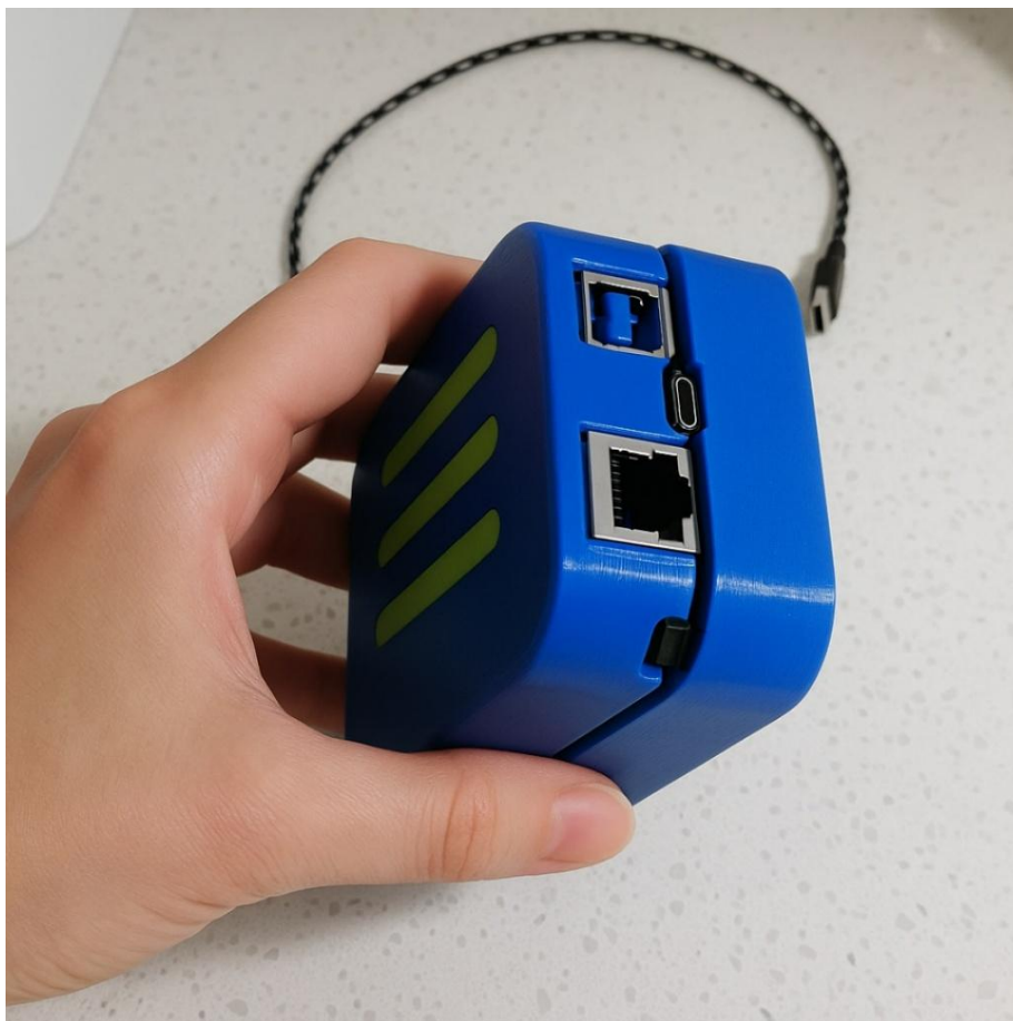
Рисунок 3.6 – Фіксація кришки та бази корпусу
