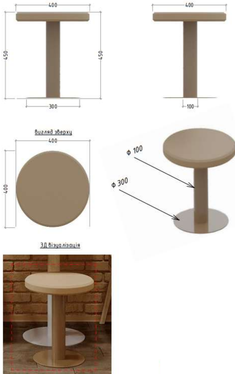
Рис. В.11 Розробка конструктивного елемента – стілець
